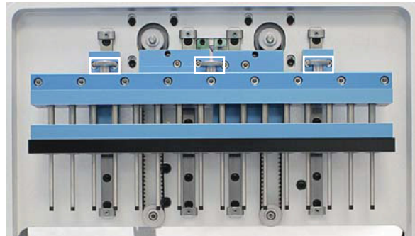
Afbeelding 38. Magnetische staafeenheid voor LEV en vingerschroeven.
