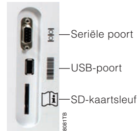
Afbeelding 5. Communicatiepoorten aan de zijkant van het instrument. Dit zijaanzicht toont de communicatiepoorten voor het instrument. De USB-poort wordt gebruikt voor bevestiging van de lezer voor streepjescodes.
